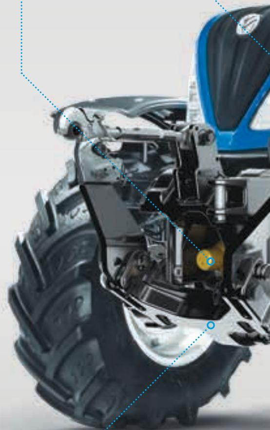
Fronthubwerk mit bis zu 1.970 kg Hubkraft; Frontzapfwelle auf Wunsch.
